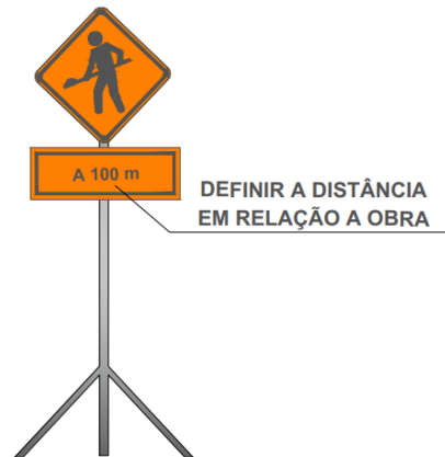
Figura 8-4 - complementação da sinalização temporária de obra
